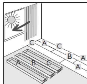
Vor der Verlegung der Elemente muss die Mittelachse des Raumes festgelegt werden. Diese ist abhängig von Raumform und Design Ihres Bodens. Starten Sie mit dem Verlegen in der Mitte des Raumes. Dielen werden immer von der Mitte aus zum Rand hin festgedrückt. Die Verlegerichtung wird entsprechend des Verlegeplans und ggf. unter Berücksichtigung der Verlegepfeile festgelegt
