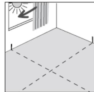
Die zu beklebende Fläche wird mittels Schlagschnur angezeichnet, um nach der Wiederaufnahme der Elemente den Klebstoff aufzutragen. Die Angaben des Klebstoffherstellers sind zwingend einzuhalten. Setzen Sie die Verlegearbeiten erst fort, nachdem die Anfangsreihen fest fixiert sind. Nutzen Sie ausschließlich die von uns in der Klebstoffempfehlung freigegebenen Produkte.
