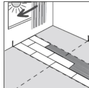
Ziehen Sie bei der weiteren Verlegung abschnittsweise den Klebstoff nach Herstellerangaben vor und fügen Sie anschließend die nächsten Elemente exakt zusammen, indem Sie die Elemente mit leichtem Druck in das Kleberbett legen. Wichtig ist es, den Bodenbelag fugendicht und spannungsfrei zu verlegen. Die Teilflächen sind unmittelbar vor der weiteren Verlegung mit einer geeigneten Handwalze anzuwalzen.
