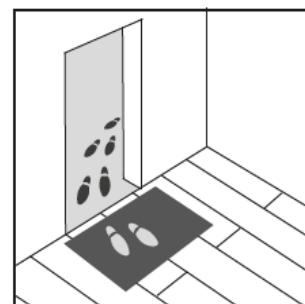
Im Bereich von bodentiefen Fenstern oder Überkopfverglasung ist für ausreichend Beschattung zu sorgen, damit die Oberflächentemperatur des Bodenbelags die Grenze von 29°C nicht überschreitet. In Bereichen mit zu erwartender höherer Temperaturbelastung oder erhöhter Oberflächenfeuchtigkeit sollten 2 Komponenten-Klebstoffe verwendet werden.
