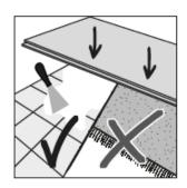
Schwimmend verlegte Altbeläge sind grundsätzlich zu entfernen
