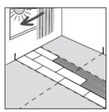
Ziehen Sie bei der weiteren Verlegung abschnittsweise den Klebstoff nach Herstellerangaben vor und fügen Sie anschließend die nächsten Elemente exakt zusammen, indem Sie die Elemente mit leichtem Druck in das Kleberbett legen. Wichtig ist es, den Bodenbelag fugendicht und spannungsfrei zu verlegen. Die Teilflächen sind unmittelbar vor der weiteren Verlegung mit einer geeigneten Handwalze anzuwalzen.
