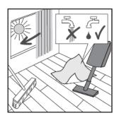
Lösung anschließend verteilen und den Bodenbelag nach kurzer Einwirkzeit mit Schrubber oder Einscheibenmaschine SRP und rotem Pad/Schrubberbürste bearbeiten. Die Schmutzflotte mit saugfähigen Breitwischmopps oder Sprühsauger mit Hartbodenadapter aufnehmen. Zum Schluss mit klarem Wasser zur Neutralisation nachwischen.
