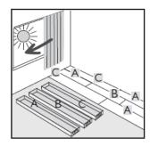
Vor der Verlegung der Elemente empfiehlt es sich, die Mittelachse des Raumes festzulegen. Diese ist abhängig von Raumform und Design Ihres Bodens. Starten Sie mit dem Verlegen in der Mitte des Raumes. Die Elemente werden fugendicht und spannungsfrei aneinander gelegt und anschließen von der Mitte aus zum Rand hin festgedrückt. Die Verlegerichtung wird entsprechend des Verlegeplans und ggf. unter Berücksichtigung der Verlegepfeile festgelegt.
