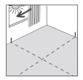
Die Größe der zu beklebende Fläche ist so zu wählen, dass diese in einem Arbeitsgang innerhalb der vorgeschriebenen Ablüft- und Einlegezeiten des Klebstoffherstellers belegt werden kann. Die Angaben Klebstoffherstellers sind zwingend einzuhalten. Setzen die Verlegearbeiten erst fort, nachdem die Anfangsreihen fest fixiert sind. Nutzen Sie ausschließlich die von uns in der Klebstoffempfehlung freigegebenen Produkte.
