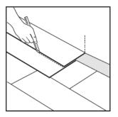
Heizköper (oder aufsteigende Bauelemente in der Fläche): Schneiden Sie das Element entsprechend zu. Bei Heizkörperrohren geben Sie bitte mindestens 5 mm zum Durchmesser des Heizungsrohres dazu.
