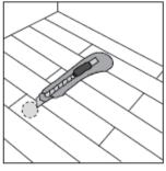
Entfernen Sie den Altklebstoff vollständig vom Untergrund. Der neue Klebstoff wird mittels geeigneter Zahnspachtel aufgetragen. Anschließend legen Sie das Element in das neue Kleberbett, streichen es vorsichtig fest
