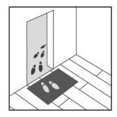
Im Bereich von bodentiefen Fenstern oder Überkopfverglasung ist für ausreichend Beschattung zu sorgen, damit die Oberflächentemperatur des Bodenbelags die Grenze von 29°C nicht überschreitet. In Bereichen mit zu erwartender höherer Temperaturbelastung und / oder erhöhter Oberflächenfeuchtigkeit müssen 2 Komponenten-Klebstoffe verwendet werden.
